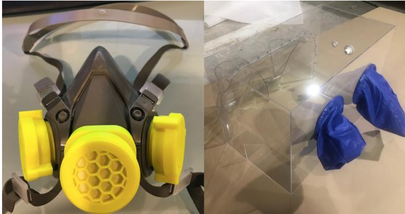
Masques de protection fonctionnant avec des cartouches rechargeables (à gauche) ; boîtiers d'intubation (à droite)
